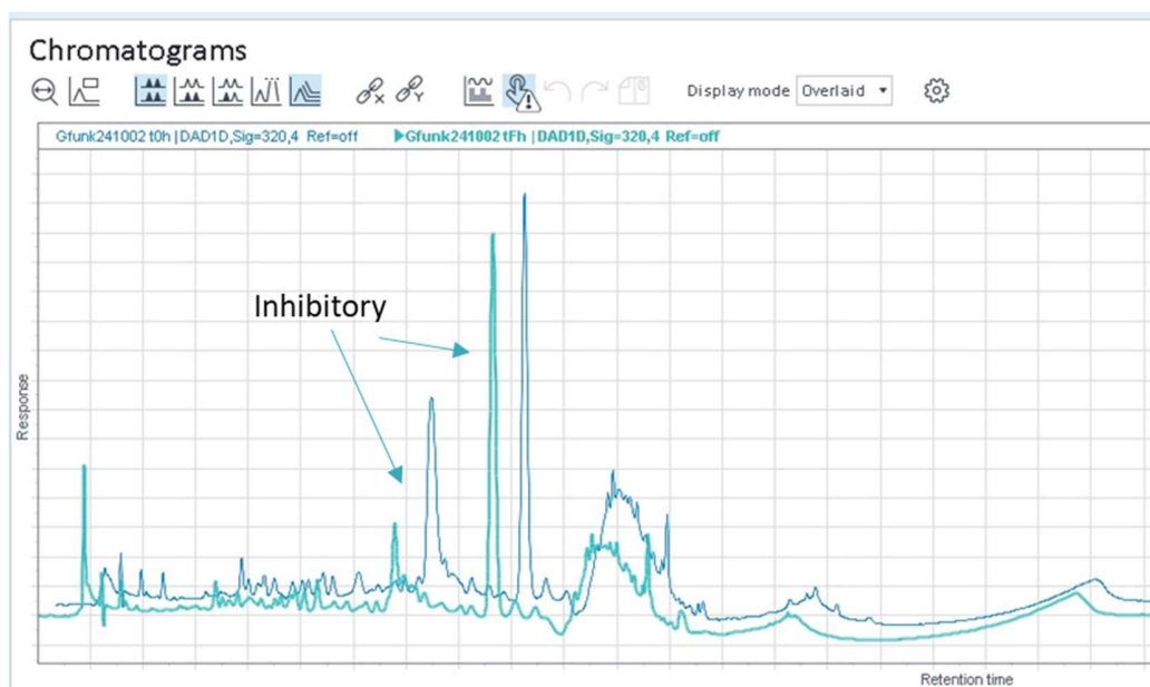
Obr. 5: Chromatogramy kapalné fáze před (modrá křivka) a po fermentaci (zelená křivka) pro UHPLC stanovení inhibitorů z hydrolyzy.
