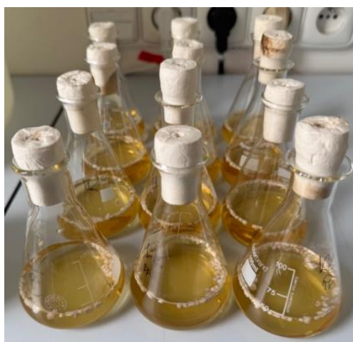
Obr. 5 Názorná ukázka připravených médií ke kultivaci zaočkovaných perlitovými nosiči s imobilizovanými bakteriemi
