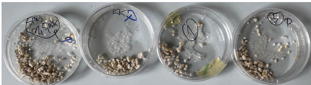
Obr. 3 Snímek zobrazující perlitové nosiče s imobilizovanými bakteriálními buňkami.
