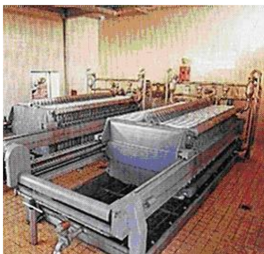
Obr.14 - Provozní deskový křemelinový filtr
